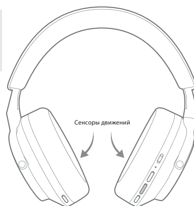
Diagram 3 Расположение сенсоров приближения
